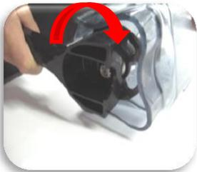
6. 칼날 렌치를 이용하여 한손으로 용기를 잡고 칼날 렌치를 이용하여 용기 바닥의 동그란 칼날 너트 홈에 맞추어 끼운 후 시계방향(화살표방향)으로 돌려서 조립합니다.
